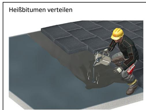
Dämmplattenkanten in Heißbitumen tauchen
