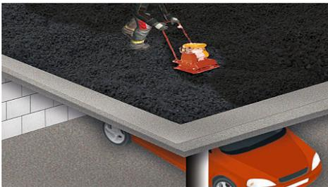
Trennlage mit Überdeckung verlegen
