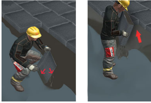
Platten diagonal einschieben
