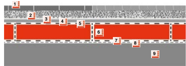
Flachdach begehbar mit Plattenbelag auf Kies
